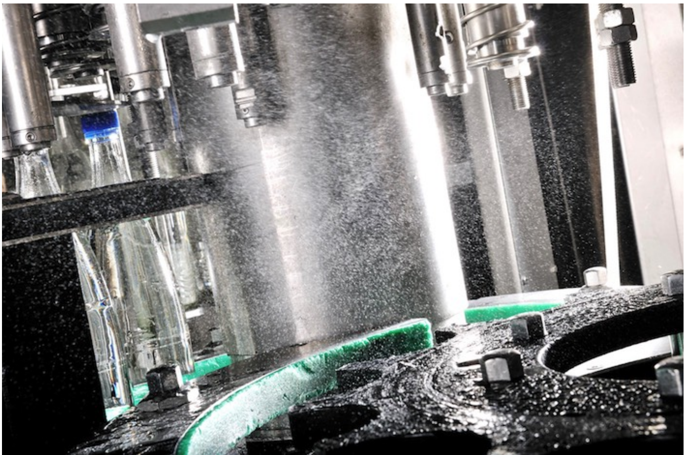
18'000 Flaschen jagen pro Stunde durch die Maschine, werden befüllt und verschlossen. Foto: zvg
