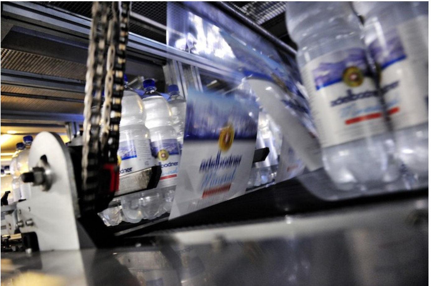
Zum Sechserpakt gebündelt, wird eine Folie mit Tragegriff um die Flaschen gelegt ...Foto: zvg
