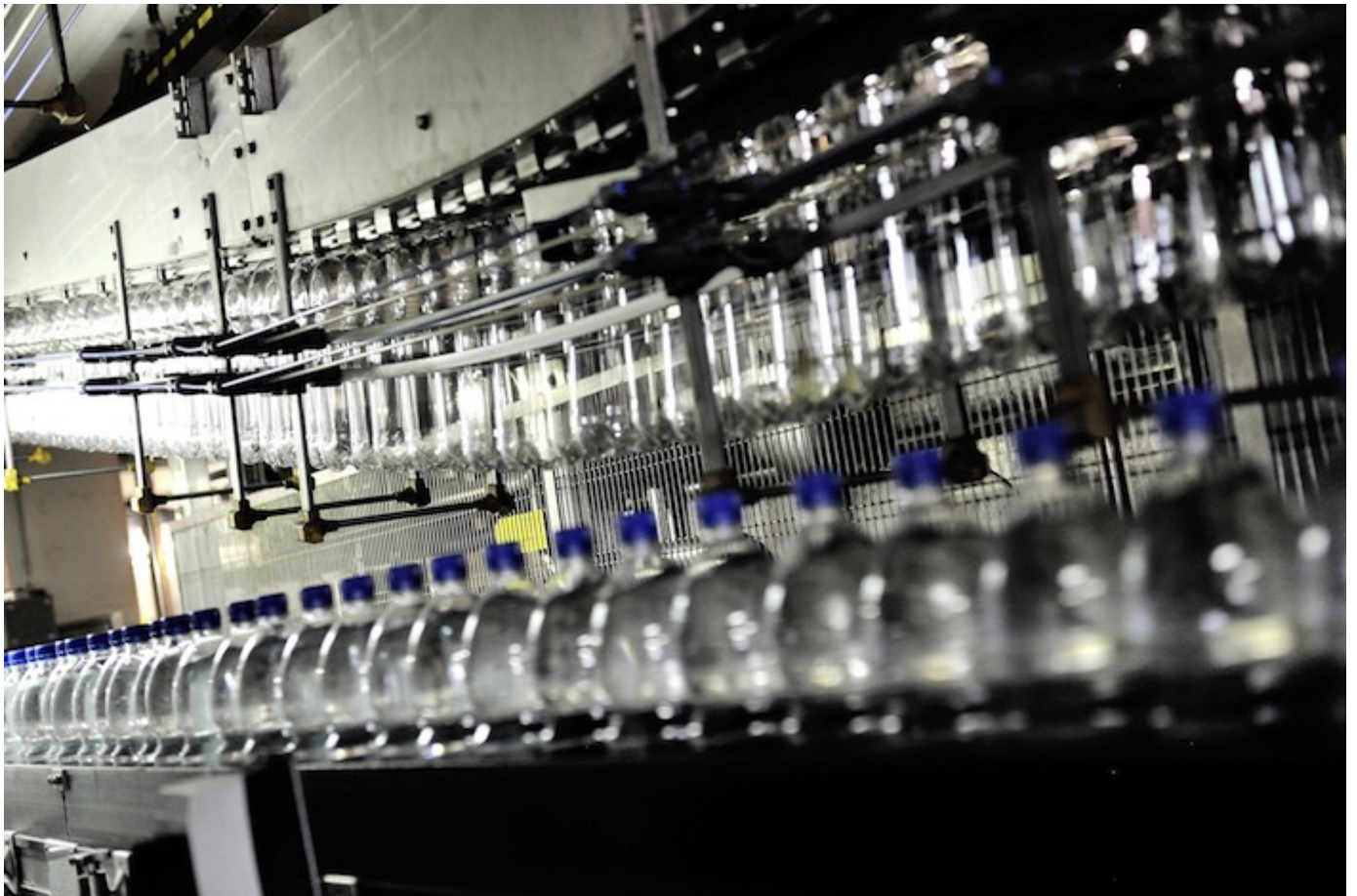
Während hinten die leeren Flaschen hängend zur Abfüllanlage transportiert werden, sind vorne auf dem Fließband bereits volle und verschlossene Flaschen zu sehen. Foto: zvg
